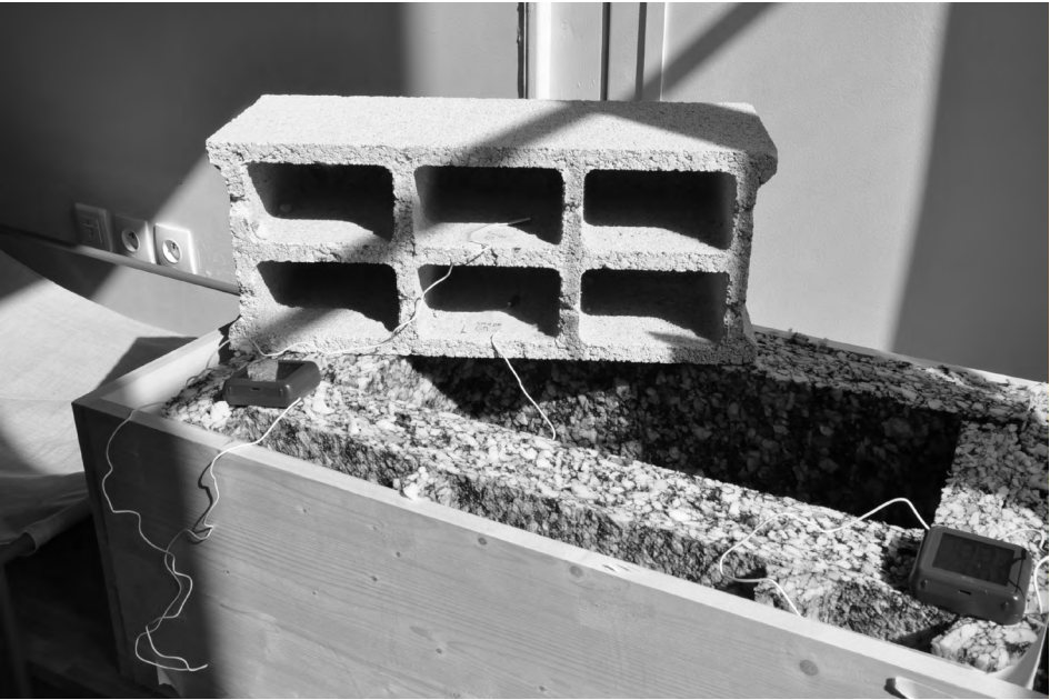
SAME, positionnement des sondes pour l'expérience du refroidissement passif, photographie, 2025.
